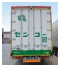
高輝度反射テープ貼り付けトラック
