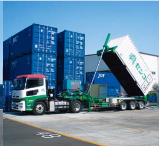
ロータリーバルブ、ルーツブローア、 発電機搭載型特殊シャーシ
