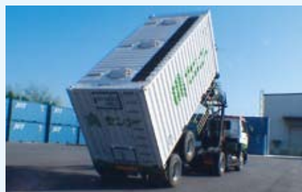
20フィートのバルク専用コンテナ。工場での直接充填後は外気に触れることなく、納入先の原料サイロへ直接投入できる
