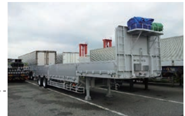
▲床高1m(通常1.4m)の低床シャーシを導入、積載重量を約1.6倍に向上
