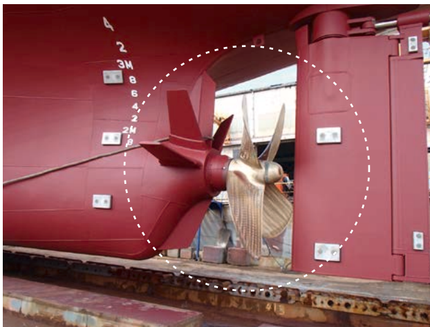
スターンフィン(プロペラの左上肩)と大口径プロペラ
