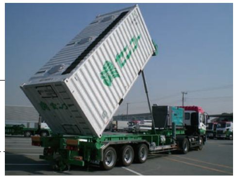
▲メーカーと納入先のサイロをつなぐバルクコンテナ物流
