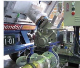
▲特許取得の「粉粒体・高シールド型ロータリーバルブ」
