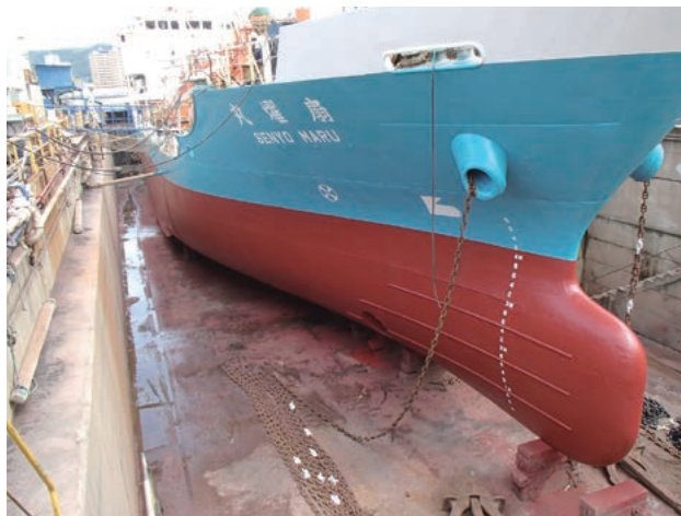
省燃費型の船底塗料を使用した船舶
