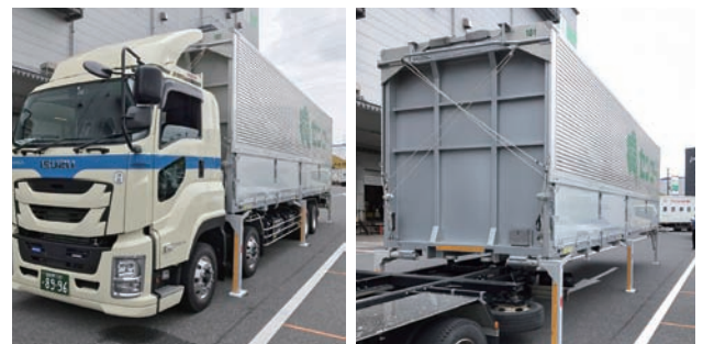
荷台となるコンテナと用途に応じて積み替えられる大型脱着コンテナトラック
