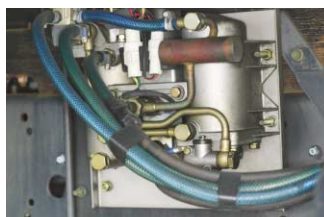
燃料タンクに取り付けられた燃費計。計測された燃費状況を車内で確認することが可能。
