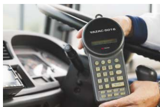
燃料タンクに取り付けられた燃費計。計測された燃費状況を車内で確認することが可能。
