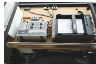
旅客バスに搭載されたX-Yレコーダ。走行中の車内の揺れを記録。
