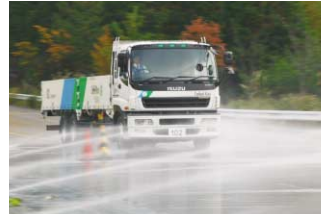
4t、10tトラックに乗って40km/h、60km/h、80km/hで走行し、濡れた路面上で急ブレーキをかける。ブレーキをかけてから停車するまでの距離を確認し、制動の限界を実体験する。
