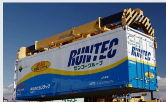
デリケートな食品を傷めない免震構造の独自コンテナ
