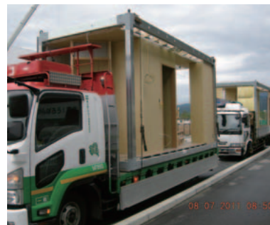
仮設住宅部材を積んだ復興支援車両
