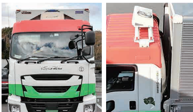
アイドリングストップ支援「蓄電式ルームクーラー」装着トラック
