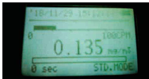
粉じん作業場所の測定値表示例
