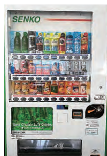
センコーの物流センターへの設置が進む(株)スマイル取り扱いの省エネ型 ノンフロン冷媒飲料自動販売機
